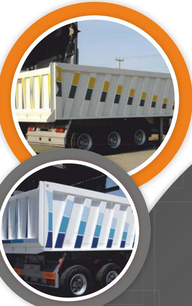
الهيكل: يتم تصنیعه من ورقه الجودة Ereyli-erdemir al والشبکات مصنوعة من ٨٠ npi ، الهيكل السفلي ٢٢٠ npu ، الهيكل العلوي مصنوع من ١٦٠ npu ، اختيارياً يمكن طباعته من الورقة.
